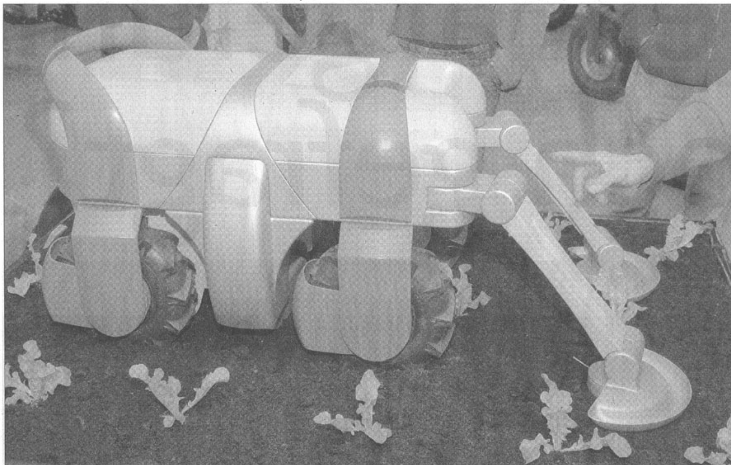
Formvollendeter Jätroboter: Der Weedmaster soll via GPS-System den richtigen Weg finden. Eine digitale Kamera unterscheidet zwischen Unkraut und Kulturpflanze. (Bild: röt)
